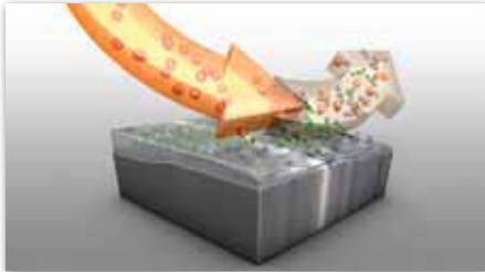
Fint fyldstof slåes ud af store partikler
