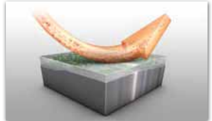
Fyldstof i samme størrelse som slidpartikler giver bedst beskyttelse
